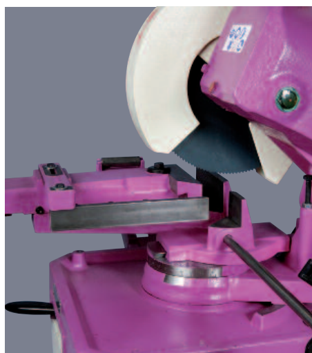
Embrayage assurant la longévité de la machine et safeguardant la fraise scie
