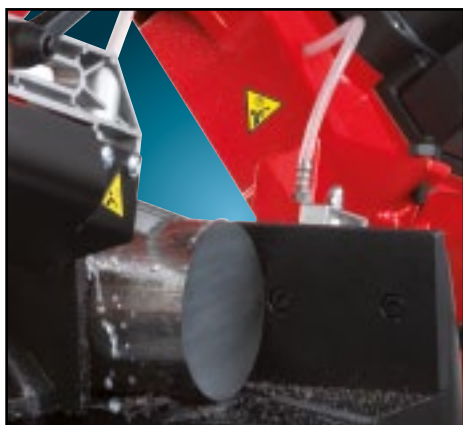
Taglio con lubrificazione. Coupe avec lubrification.
